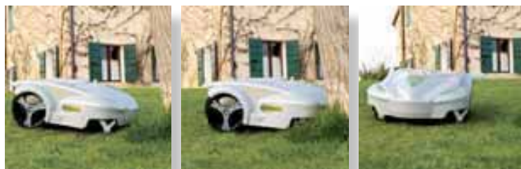
Roboten møter en hindring, stopper, går tilbake og endrer retning.
